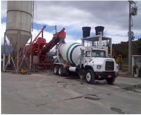
Foto No. 3 Se observa la dosificadora de concreto con la mixer.
